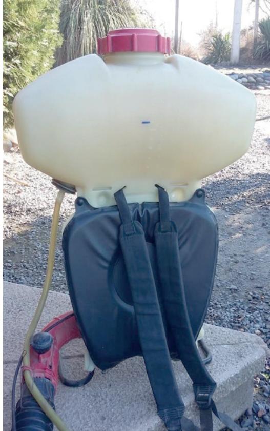
Figura 7.5. Marca del nivel de agua en el estanque del pulverizador ubicado en sitio nivelado.
