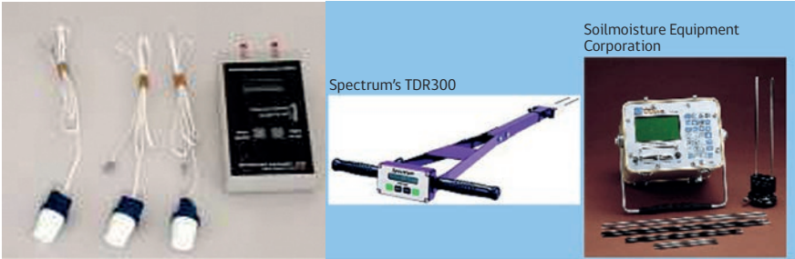
Figura 5.5. Bloques de yeso y sensores de capacitancia.
