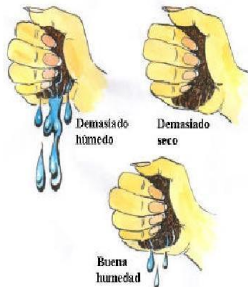
Medición de la Humedad
